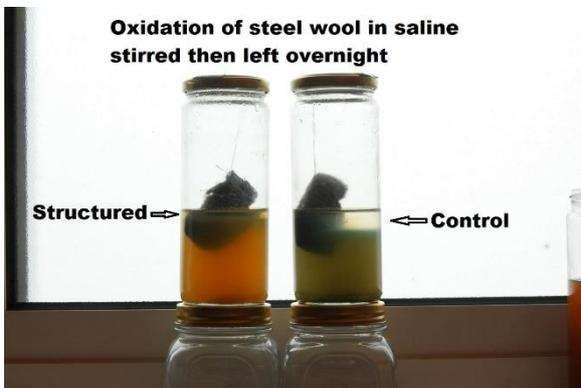
Dann begann der Rost in der Kontrollprobe (rechts) in einem Bereich um die Basis der Wäscheklammern zu agglomerieren.
